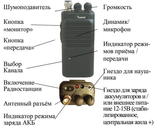
Регулятор шумоподавления при отсутствии полезного сигнала установите в положение, соответствующее отсутствию шумов. При этом учитывайте, что дальнейший поворот регулятора после срабатывания порога шумоподавления уменьшает чувствительность приёмника и дальность радиосвязи.
